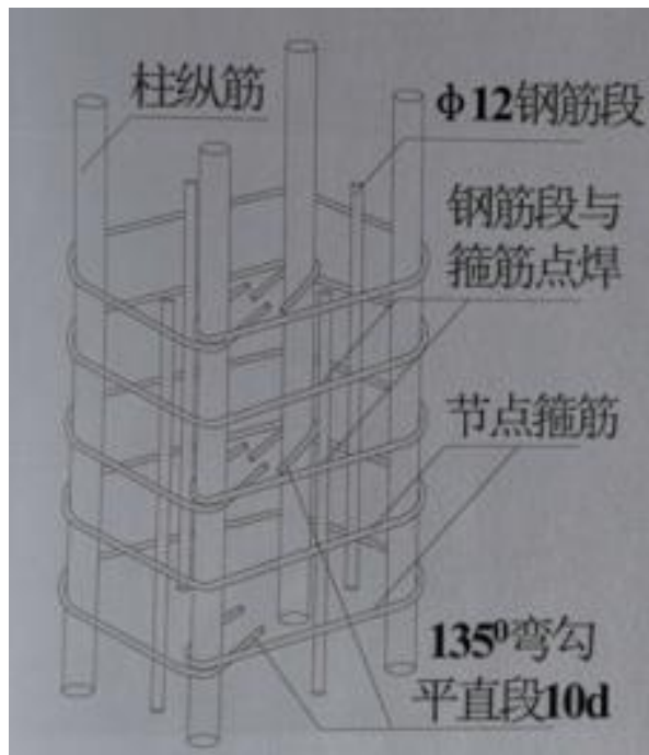
柱头箍定位用辅助箍筋笼示意图
