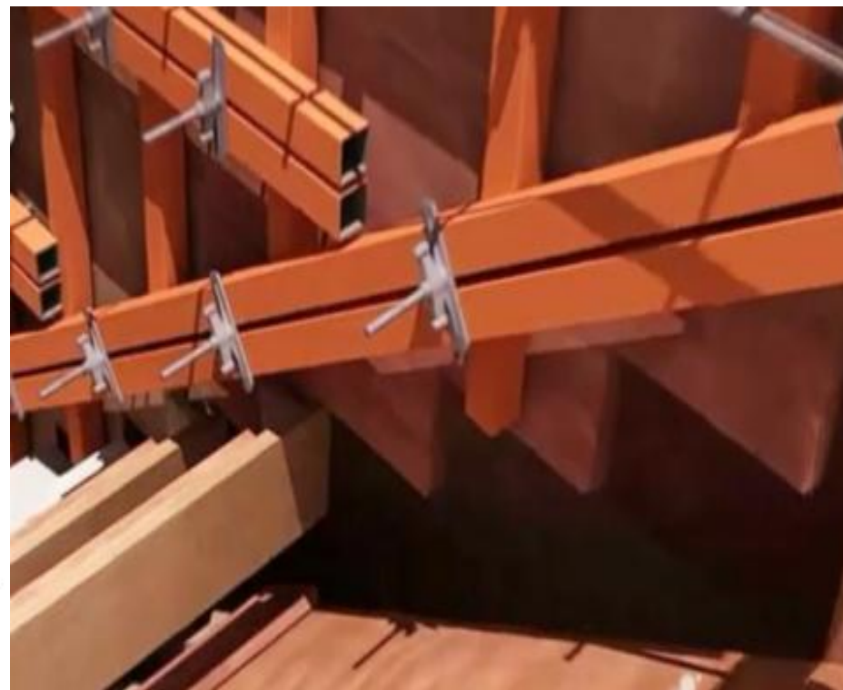
与楼梯踏步相连的墙体模板节点示意图
